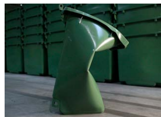
Test bestanden keine Risse keine Brüche!
