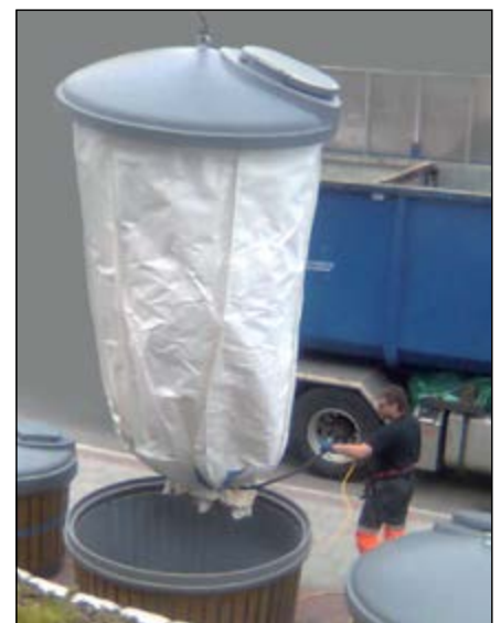
Schnelle Entleerung durch "Ein-Haken-System"
