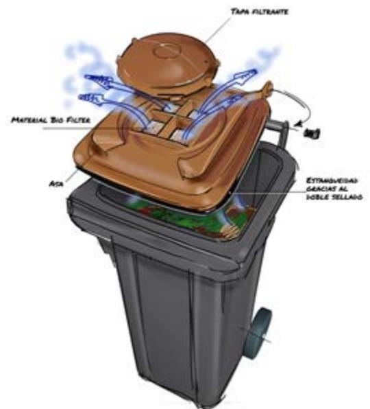
Construcción de la tapa Bio Filter
