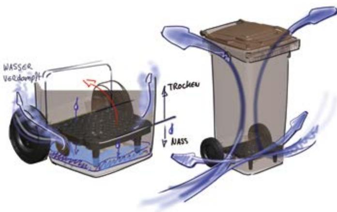
Der Bioboden wurde exklusiv für unsere neue CL Serie entwickelt. Er ermöglicht ein Abtropfen der Flüssigkeit des Bioabfalls nach unten. Die separierte Flüssigkeit verdunstet durch die Belüftungssiebe an den seitlichen Behälterwänden. Der Abfall trocknet, wird leichter und die Geruchsbelästigung nimmt ab. Der Bioboden kann nach oben weggeklappt werden, so dass die Abfallreste bei der Behälterentleerung herausfallen und der Behälter leicht zu reinigen ist.
