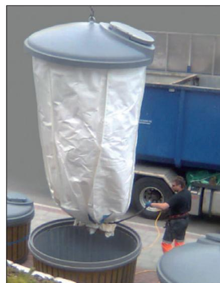
Vidange rapide avec système à simple crochet
